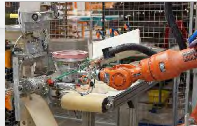
Konturschneiden des Henkels Contour cutting of the handle
