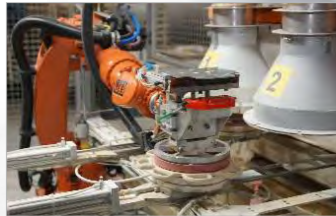
Aufnahme des durch Druckguss hergestellten Henkelrings durch den Roboter Pickup of the pressure-cast handle ring by the robot
