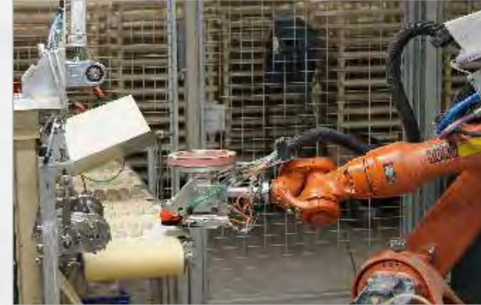
Ablegen des Henkels auf Platte Dropping the handle onto the plastic plate
