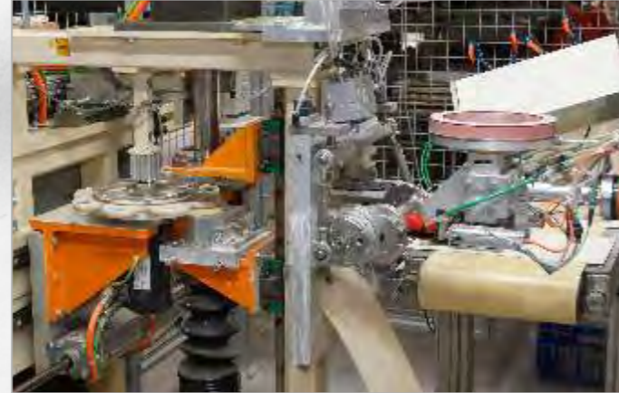
Verputzen des Henkels Finishing of the handle
