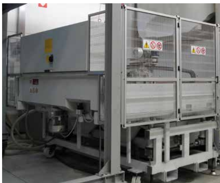
Traditional filler box with electric drive Carrello tradizionale a movimentazione idraulica Carro tradicional de movimentación eléctrica
