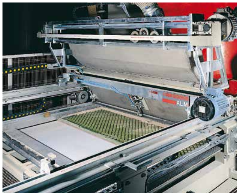
Close-up photo of adjustable universal hopper Particolare della tramoggia universale regolabile Detalle de la tolva universal regulable
